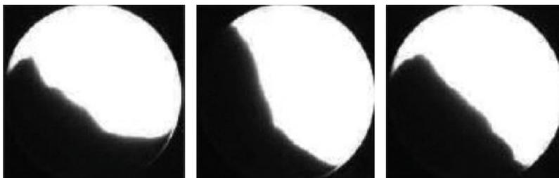
Un tamburo con due finestre in quarzo, riempito per ca. 1/3 del suo volume con il campione, viene posizionato in verticale su due cuscinetti che lo fanno ruotare in senso orario. Una luce viene usata per illuminare il campione e creare un effetto analogo alle ombre cinesi.
