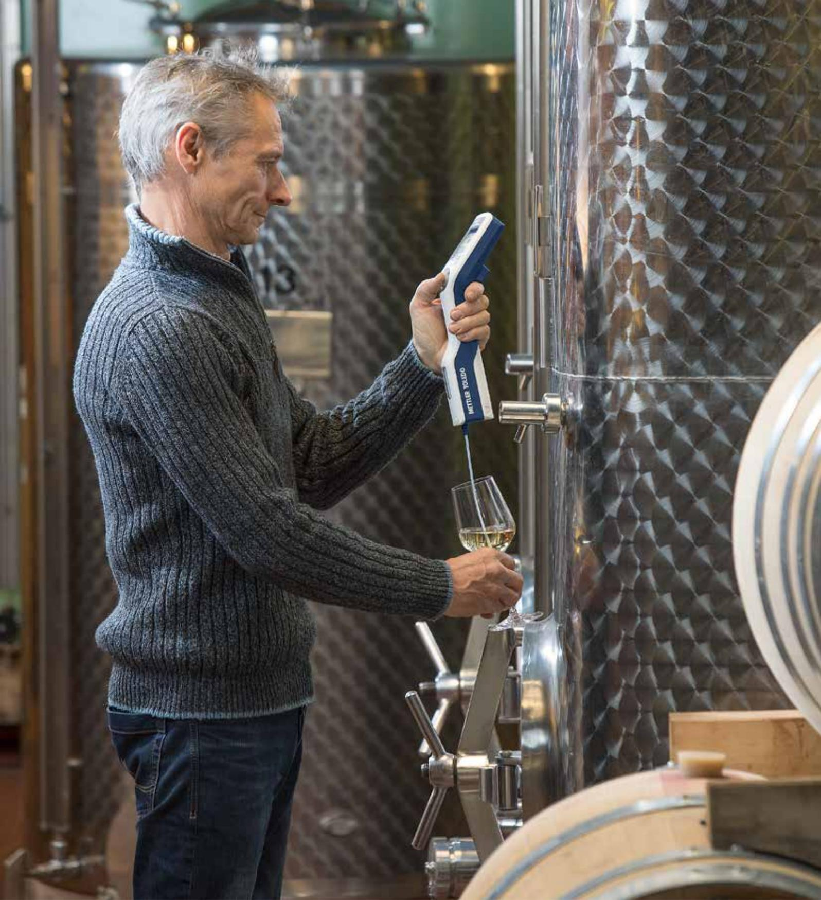
Appositamente concepito per l'uso in movimento, Densito è perfetto per qualsiasi applicazione: dalla verifica del grado di maturazione o fermentazione dell'uva alla qualità delle materie prime in ingresso o dei prodotti finali. Determinate densità, gravità specifica, grado Brix e altri parametri utilizzando i calcoli integrati nello strumento. Il suo design esclusivo consente il funzionamento con una mano sola, lasciando l'altra libera di aiutarvi nel processo di campionamento.
