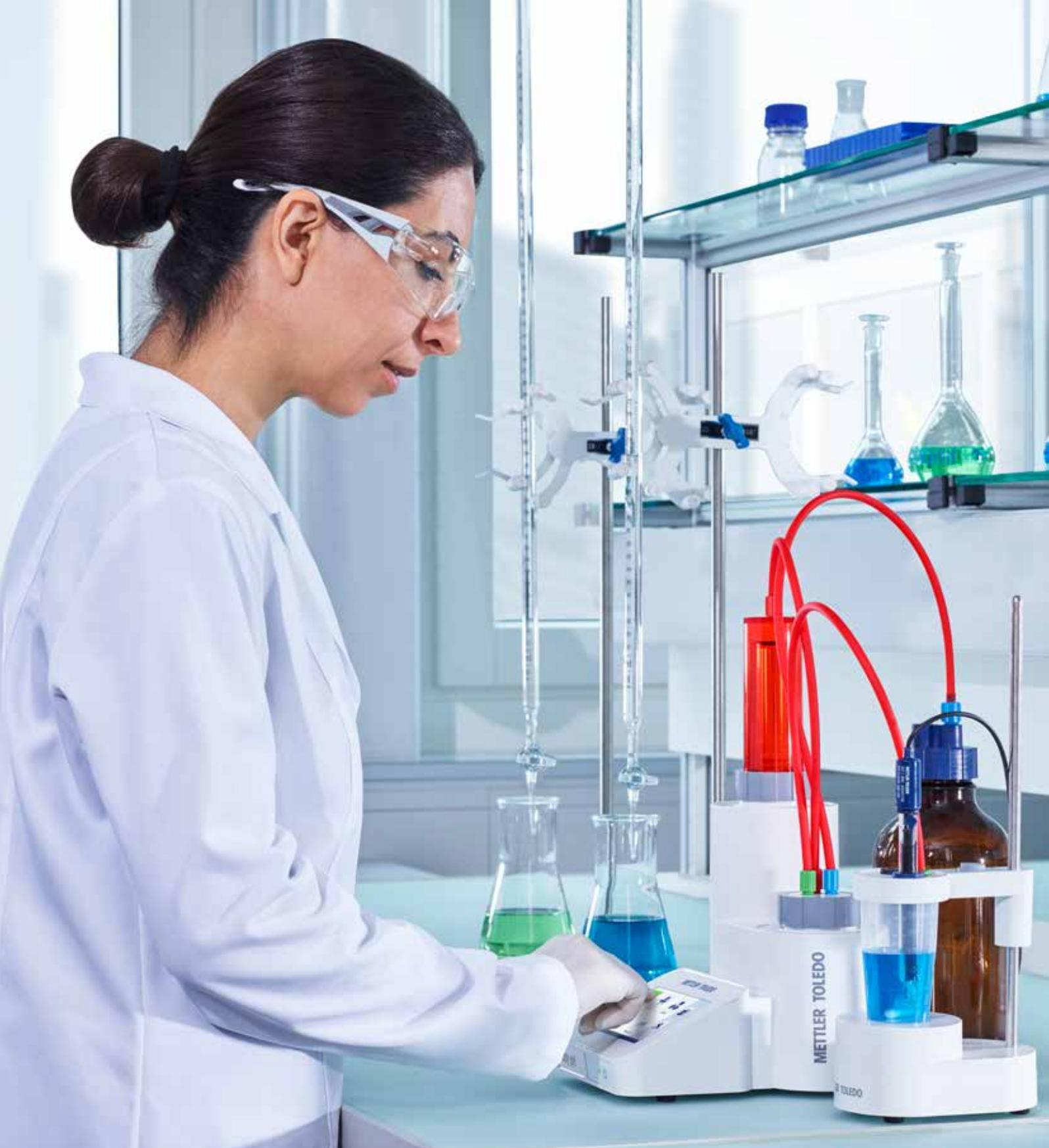
Ridurre l'utilizzo di sostanze chimiche e campioni è molto importante in tutti i laboratori. I titolatori, dotati di buretta automatica, permettono di analizzare campioni di dimensioni ridotte e, di conseguenza, utilizzare un quantitativo di titolante inferiore.
