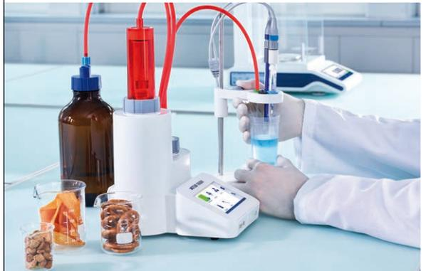
Questo apparecchio è stato appositamente progettato per rendere più agevole la misurazione della quantità di sodio presente negli alimenti, mediante il metodo di aggiunta standard. È sufficiente aggiungere un campione e una soluzione per la regolazione della forza ionica (ISA), quindi procedere con la misurazione. Nient'altro. Non è nemmeno necessario tarare il sistema. L'analisi specifica del sodio non è mai stata così semplice.
